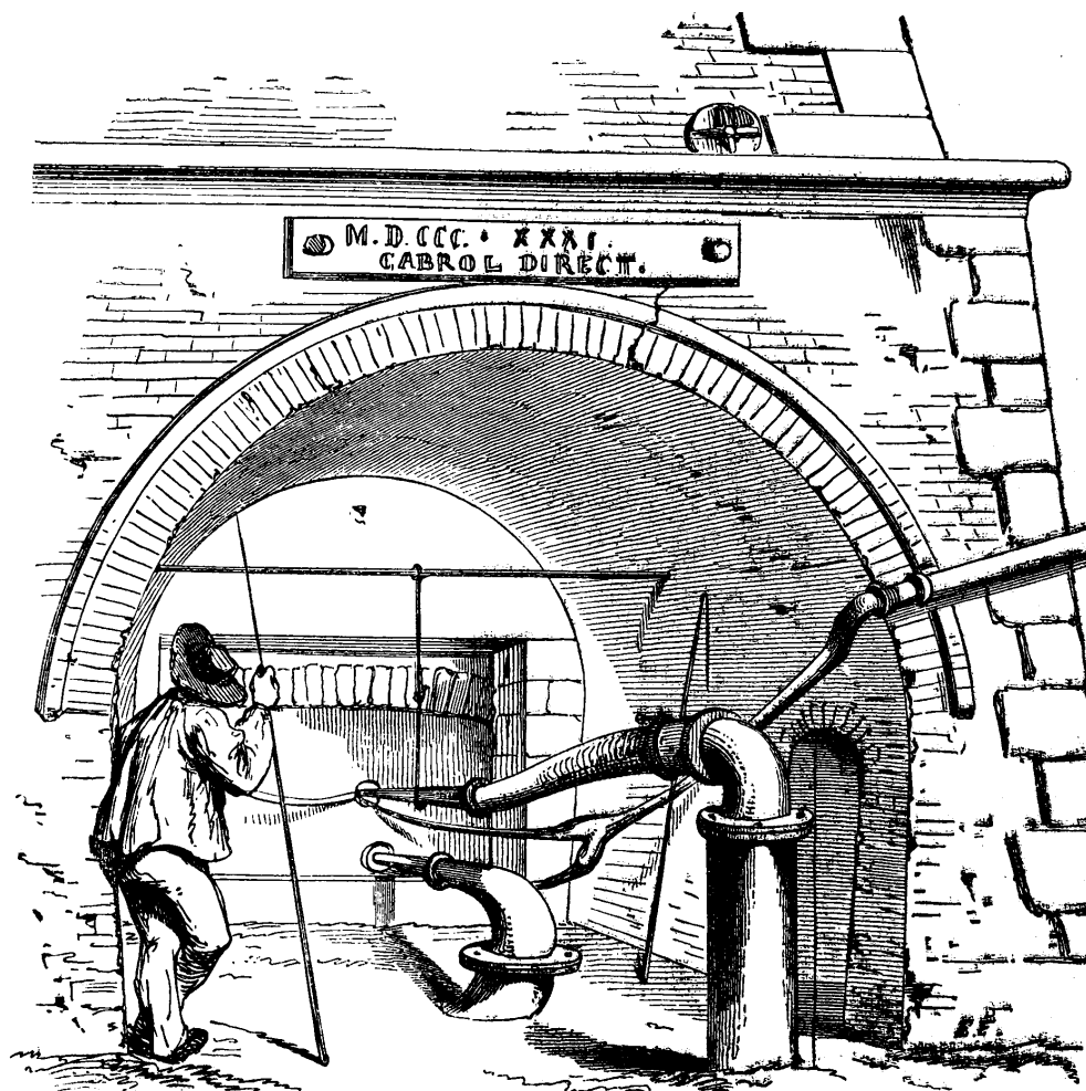
Les tuyères, à la base du haut fourneau, Decazeville (Dessin publié en 1846, Illustration)
